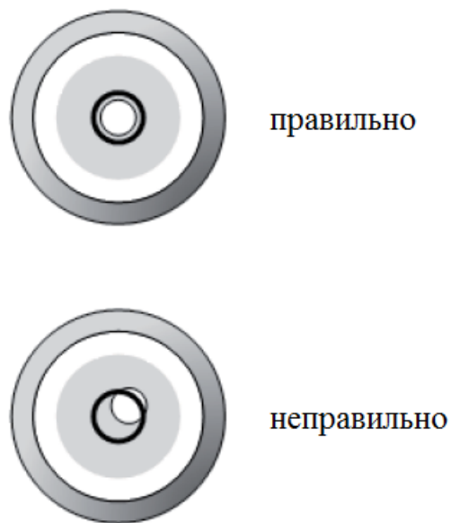
Рисунок 2 — Контроль наклона основания с помощью пузырькового уровня
